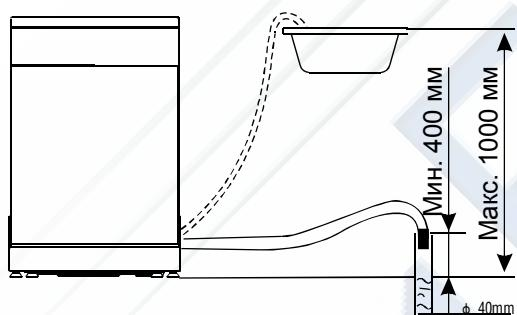
Сливной шланг подсоединяется к сливной водопроводной трубе диаметром не более 4 см либо выводится в кухонную мойку. Следите, чтобы шланг не сгибался и не перекручивался. Используйте специальное опорное колено (кронштейн) из комплекта поставки. Сливная горловина должна располагаться на высоте от 400 до 1000 мм. При этом ее нельзя погружать в воду во избежание обратного засасывания.
